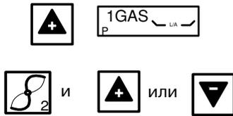
После установки параметров для 3-ступени, кнопкой **Плюс** выбрать 2-ступень. На дисплее высветится **3OIL**. Удерживая нажатой кнопку **2**, другой рукой нажатием кнопок **Плюс** или **Минус** можно задать значение мощности 2-ступени от 0° до 90°.
