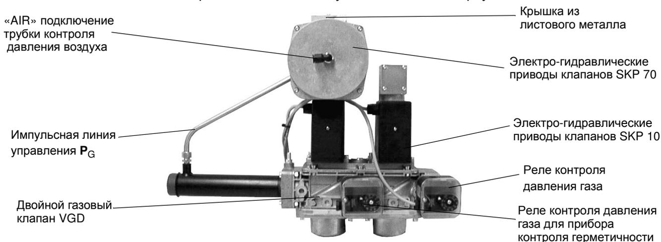
Выполнить соединение воздушной линии управления (синяя трубка) от штуцера «AIR» на компактном блоке к штуцеру измерения давления воздуха на газовой обойме. Трубка синего цвета служит для управления компактным газовым блоком и должна пролегать в свободном изгибе, без переломов.
