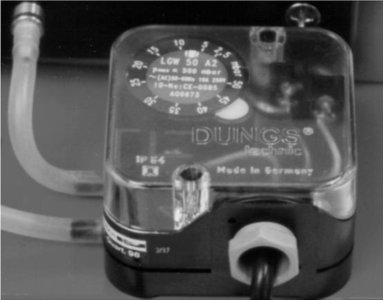
Реле контроля давления воздуха работает как дифференциальное реле давления и служит для контроля давления у горелок с наддувом.
