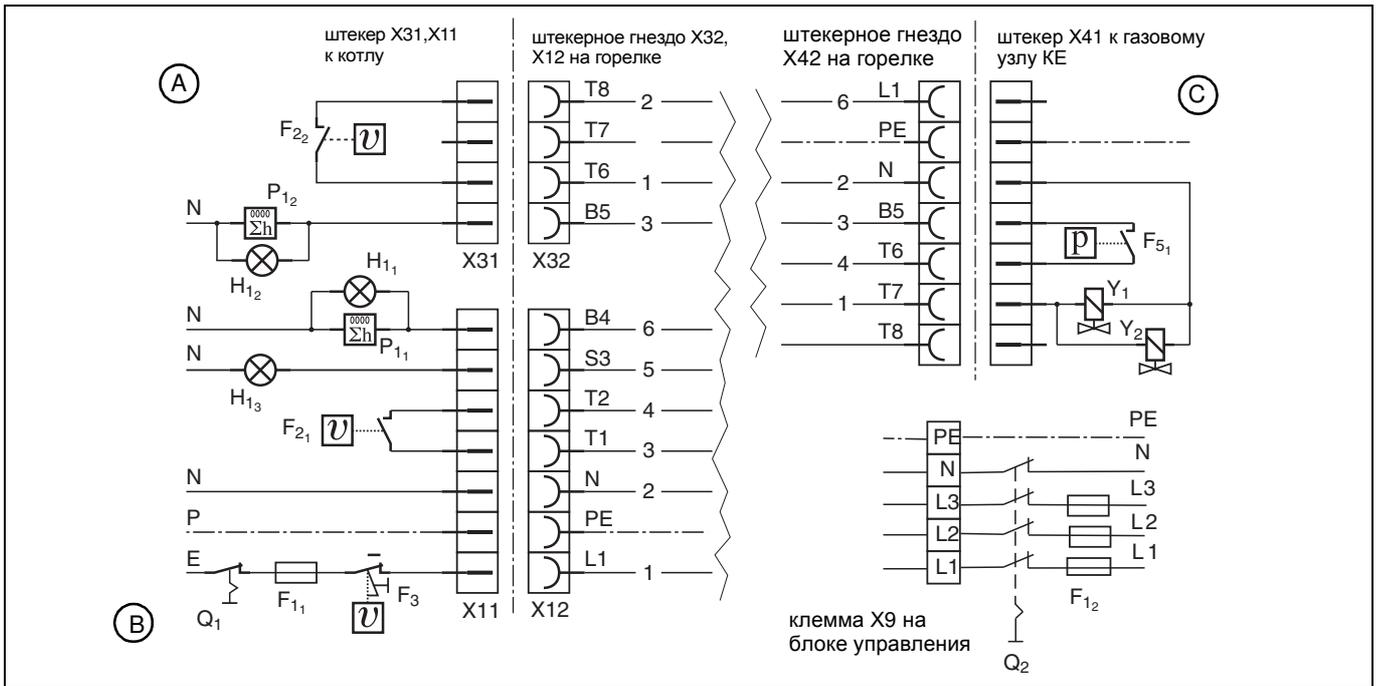
F<sub>11</sub> предохранитель макс. 10 A
