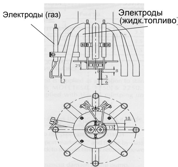
Расстояние (зазор) между электродами и форсункой установлены на заводе и должны выдерживать следующие промежуточные размеры.:
