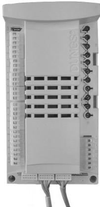
МРА 22 – топочный автомат с микропроцессорным управлением сервопривода, для контроля и управления пневмо-модулирующей горелкой и с интегрированным прибором контроля герметичности клапанов. Топочный автомат МРА 22 оснащён шиной передачи данных e-BUS. При непрерывной работе в течении 24 часов блок управления МРА 22 выключает горелку на короткое время (20-30 сек.) для проверки всех установок, включая проверку герметичности клапанов.
