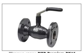
Шаровые краны **RJIP Premium DN15 – DN65** — двухпозиционная запорная арматура, предназначенная для использования в отопительных и промышленных установках для жидких сред. **Класс герметичности А** согласно ГОСТ 9544 «Арматура трубопроводная. Нормы герметичности затворов».
