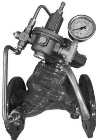
Регулятор давления **C101-Р** уменьшает и поддерживает постоянное пониженное давление «после себя» независимо от изменения давления до регулятора и водоразбора после него.
